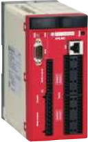
XPS-MC Çok fonksiyonlu (Maks. 32 giriş / 8 bağımsız çıkış)
