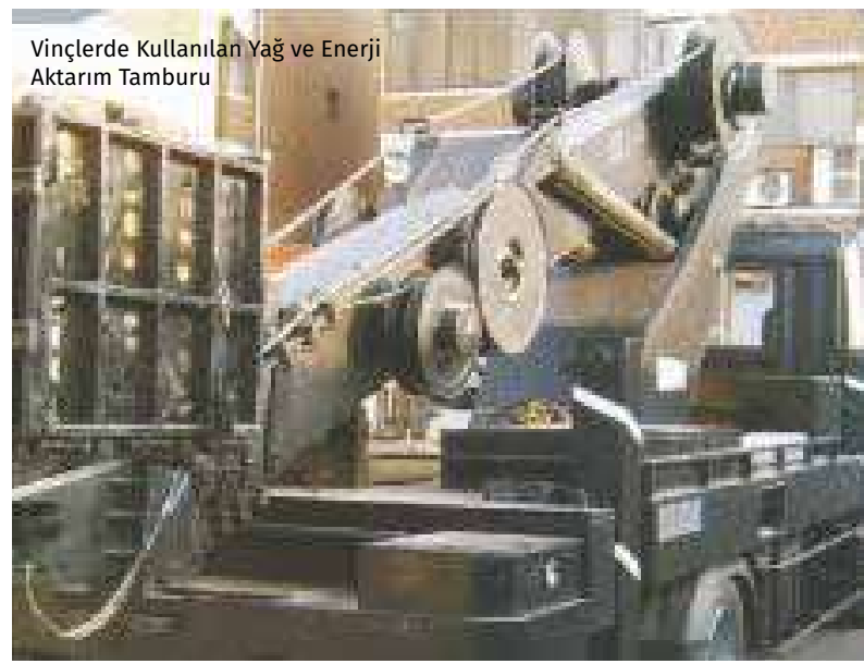
Vinçlerde Kullanılan Yağ ve Enerji Aktarım Tamburu
