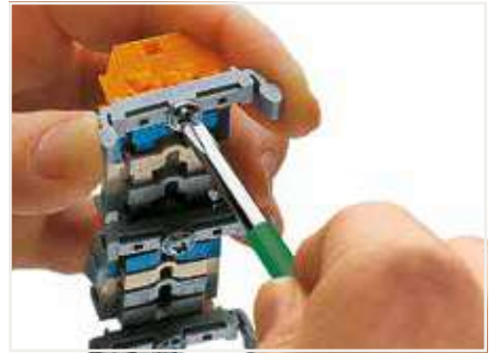
Bir montaj ayağının (209-123) montaj flanşları ile klemenslere sabitlenmesi (montaj ayakları arasındaki mesafe: yaklaşık 35... 40 mm).
