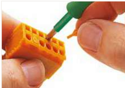
CAGE CLAMP® donanımlı erkek ve dişi konnektörlerde kullanılmayan bağlama birimlerinin kaplanması (örneğin, boşluk ve kaçak mesafesi gereksinimlerini karşılamak için pin aralığını ikiye katlarken veya daha yüksek bir nominal voltaj gerektiğinde) Kilitleme pinleri, panele monte, açılı dişi konnektörler için uygun değildir.
