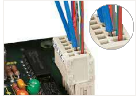
1 mm Ø test pini (Ürün No. 735-500) ile test, kontakta dokununuz.
