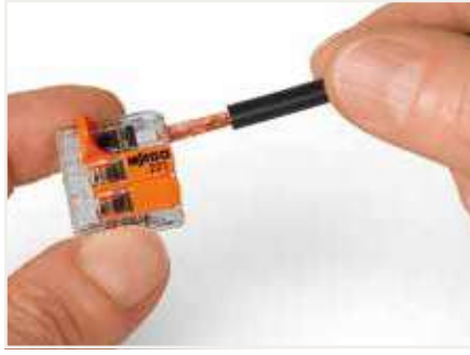
Sonlandırma: Kelepçeleme ünitesini açmak için kolu kaldırın ve soyulmuş bir iletken yerleştirin.
