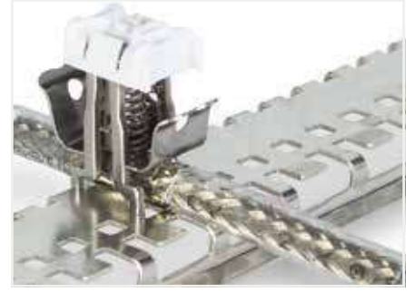
Ekran sıkıştırma modül kontakları ekran iletkeni ve özel yanıklı DIN rayı (790-145). Lütfen rayın altındaki ara modülü (790-144) kullanın.
